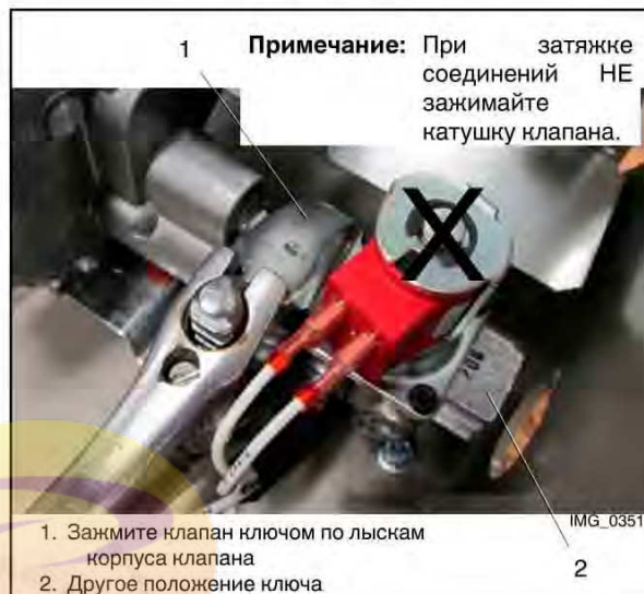
Рис. 1-8 Удержание топливного клапана при затяжке топливных соединений
