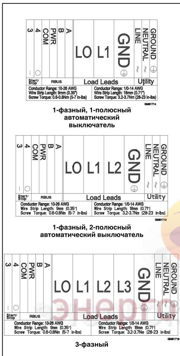
Рис. 1-19 Наклейки с указанием соединений клеммного блока
